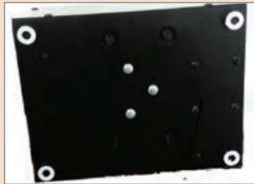
شکل ۱-۴ سه پیچ قفل کننده کمپرسور به بدنه
