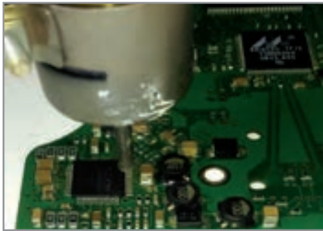
شکل ۲-۴ دمونتاز آی سی های چهار طرفه (خرچنگی)
